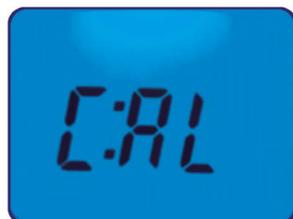
Nel caso in cui il dispositivo registri un cambiamento repentino di temperatura, sul display comparirà un conto alla rovescia che indica il tempo necessario alla stabilizzazione: sarà sufficiente attendere fino alla fine del conto alla rovescia per la stabilizzazione automatica del termometro. Questo sistema è chiamato **AQCS (Automatic Quick Calibration System)** ed è in grado di stabilizzare il termometro in circa 3-4 minuti.
